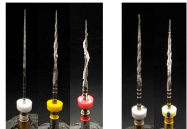
Fig 2: Imagen comparativa de las limas tras la eliminación de virutas para ilustrar las diferencias en la eficacia del corte.
