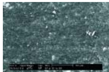
Abb. 6 Bei 500facher Vergrößerung ist eine gute Reinigung der Oberfläche mit geschlossener Schmierschicht erkennbar.
