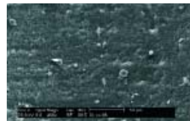
Abb. 8 Die Ausschnittvergrößerung weist wenige oberflächliche Auflagerungen bei geschlossener Schmierschicht auf (Grad 1).
