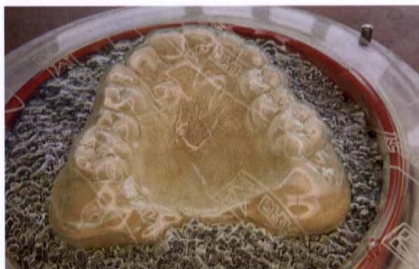
Abb. 1 Sportmundschutze werden aus elastischen Kunststoffplatten im Tiefziehgerät anatomisch geformt
