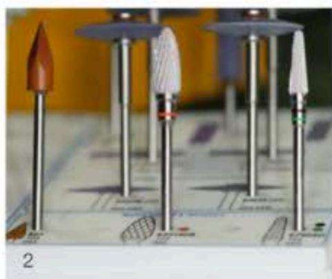
Abb. 2 Die Arbeitsteile der neuen CeraLine-Fräser von Komet besteht aus einem Keramik-Werkstoff. Rechts mit GSQ-, in der Mitte mit ACR-Verzahnung und links ein Soft-Cutter für Übergänge von Kunststoffkanten zu Metalldrähten
