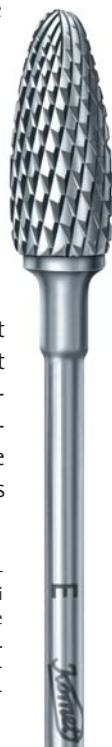
Abb. 2: Bei der E-Verzahnung erzeugen zwei Schlitze zwei Schneiden. Dies vergrößert die Länge der Schneiden und bricht den Span. Mit ihr steigt die Schneidleistung trotz geringerer Vibrationen und mit weniger Anpresskraft um rund ein Fünftel.
