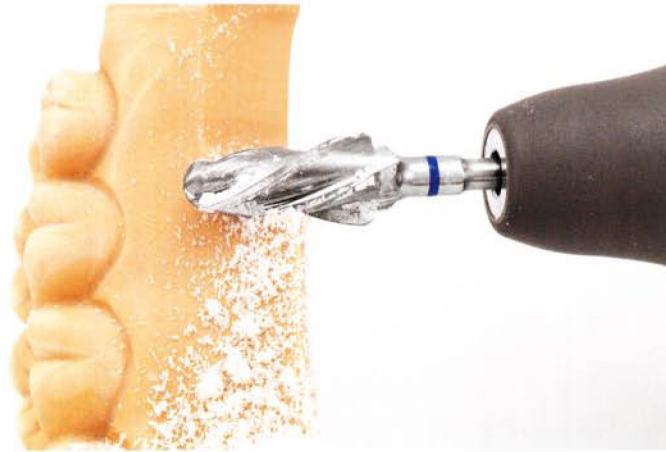
Abb. 7 Bei der groben SGA-Verzahnung pressen die Schnittkräfte das Werkzeug in die Spannzange hinein statt es herauszuziehen
