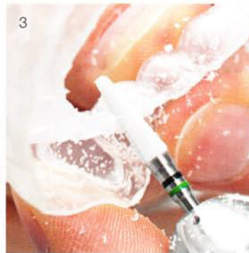
Abb. 3 Für weichbleibende Unterfütterungen, Sportmundschutze und Zahnfleischmasken benötigt man eine spezielle Verzahnung, die die Werkstoffe nicht überhitzt. Die GSQ-Verzahnung gibt es auch als Fräser mit einem Arbeitsteil aus Oxidkeramik
