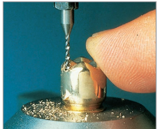
Abb. 3: Verbesserte Funktion: Dank ZTM Pfannenstiels Forschungen bohren Zahntechniker durch das Sekundärteil und nutzen die Bohrungen für Aktivierungstifte.
