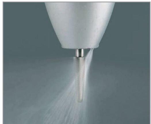
Abb. 11: Zum Schutz vor Sprüngen empfehlen Zirkon-Hersteller, den Werkstoff mit einer wassergekühlten Laborturbine zu bearbeiten.
