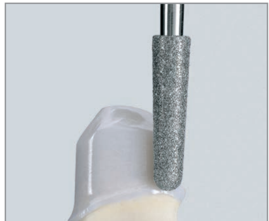
Abb. 9: Harte Zirkoniumdioxid- oder Aluminiumoxidkeramiken bearbeitet man am sinnvollsten mit ZR-Schleifern. Ihr Diamantkorn lagert in einer Spezialbindung.
