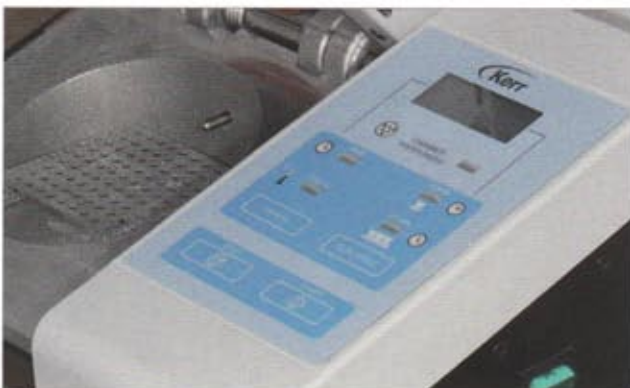
Abb. 59: Nach der Lichtpolymerisation erfolgt die Endvergütung unter Schutzgas, Druck und Hitze im Curing Unit -Gerät.
