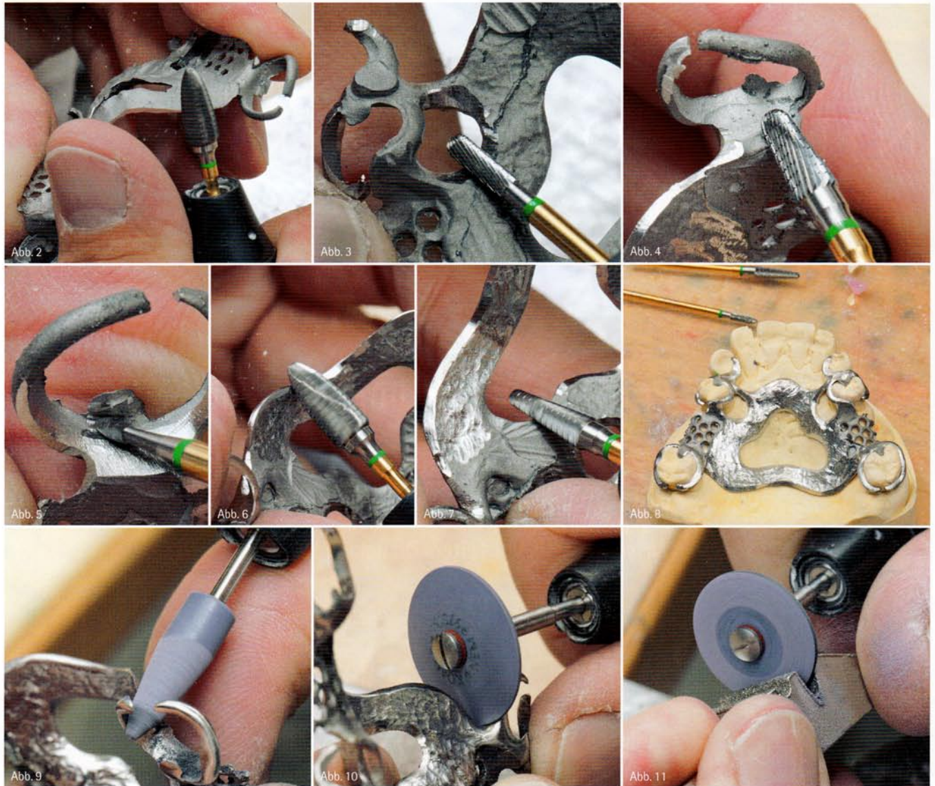
Abb. 2: Mit dem großen NEX-Fräser H251 glättet der Zahntechnikermeister die dorsale Außenform und entfernt die Überreste der Gusskanäle. Der Fräser trägt dabei ordentlich ab. – Abb. 3: Die Öffnung für das Parodontium zieht ZTM Starke mit der Form H129 nach. – Abb. 4: Ein Fräser mit einem kleinen Arbeitsteil eignet sich hervorragend für Halteelemente und Auflagen. – Abb. 5: Für Gussperlen innen an Klammerarmen ist die Ei H73 perfekt. Sie wölbt sich wie die Zahnwölbung. – Abb. 6: Effektiver Materialabtrag bei gleichzeitig glatten Oberflächen – NEX-Fräser von Komet. – Abb. 7: Wo es eng wird, nutzt man am besten den H79-Fräser ... – Abb. 8: ... er eignet sich auch bestens für die Oberflächennarbung. – Abb. 9: Zusammen mit den NEX-Fräsern ergeben die Komet NEM-Polierer ein „schlaues System“. – Abb. 10: Die Linsenform gelangt überall hin und schont die breiteren Polierräder. – Abb. 11: Ein besonderer Tipp: Mit dem Abrichtblock von Komet lässt sich jeder Polierer in die gewünschte Form bringen.
