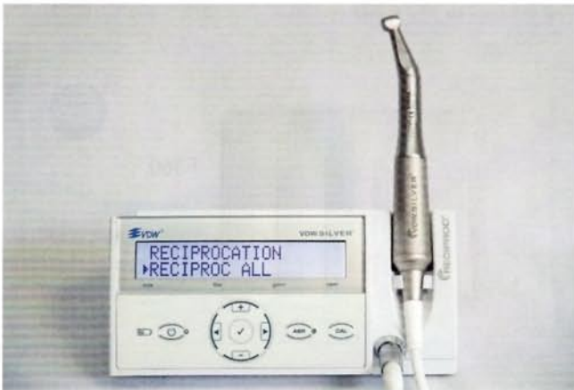
Abb. 7 Motor VDW Silver Reciproc mit Sirona-Winkelstück
