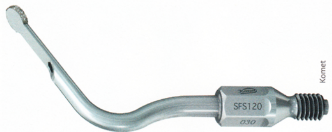
Abb. 8: Die Schallspitze SFS120 (Komet) ist zum Zahn und zur Gingiva hin glatt poliert und weist nur am dünnen kristalen Arbeitsende eine Diamantierung auf.
