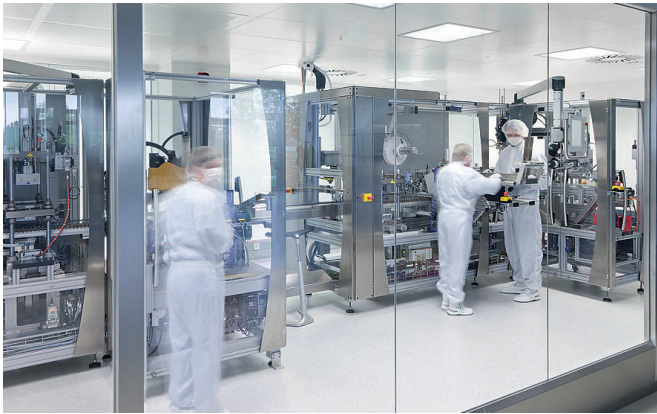
Blick in den 250 Quadratmeter umfassenden Reinraum. In diesem können nach validierten und zertifizierten Arbeitsprozessen bis zu zehn Millionen Instrumente jährlich unter Reinraumbedingungen verpackt werden.
