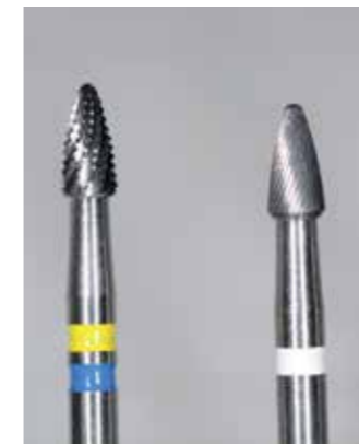
5. Fraises références H390Q 314 018 et H390UF 314018. La forme et la taille sont identiques, mais la première est surtaillée et comporte beaucoup moins de lames. Cette forme permet les retouches occlusales importantes des secteurs postérieurs et les retouches des faces linguales des incisives et canines.
