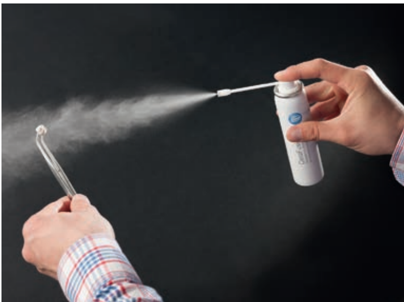
Abb. 1: CeraFusion wird dünn auf die gesinterte monolithische Zirkonoxid-Krone aufgesprüht. Die Schichtstärke wird bereits im CAD berücksichtigt und die Okklusion mit 0,01 bis 0,02 mm außer Kontakt gestellt. (Bildquelle: Komet)
