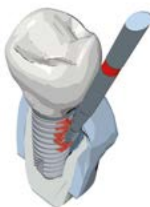
Abb. 1: Gemeinsam mit Dr. Martin Dürholt, Bad Salzufen, entwickelte Komet acht Hartmetallinstrumente in Ei- und Flammenform (H379/H379UF und H48L/H48LUF) für die intraorale Titanbearbeitung (Set 4656)
