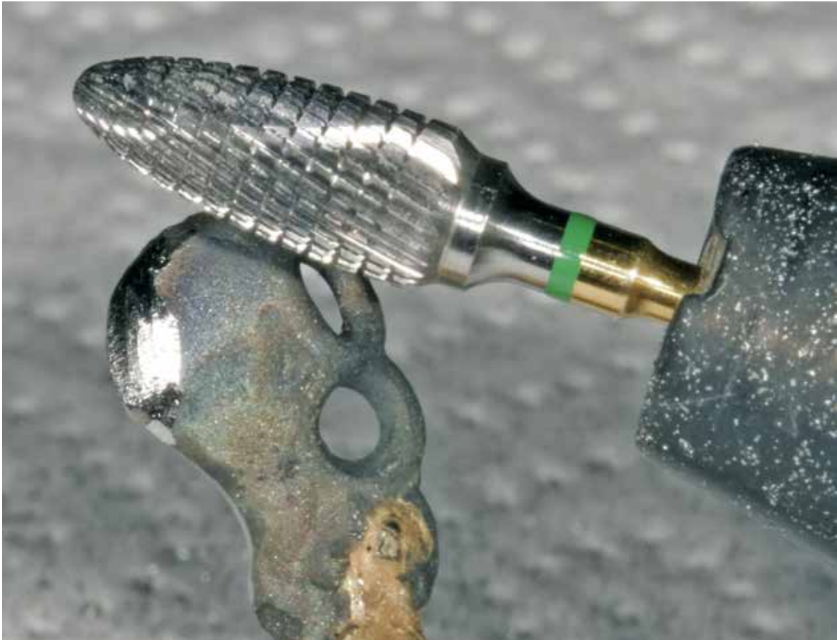
Abb. 86: Ausarbeiten mit dem NEX-Hartmetallfräser.
