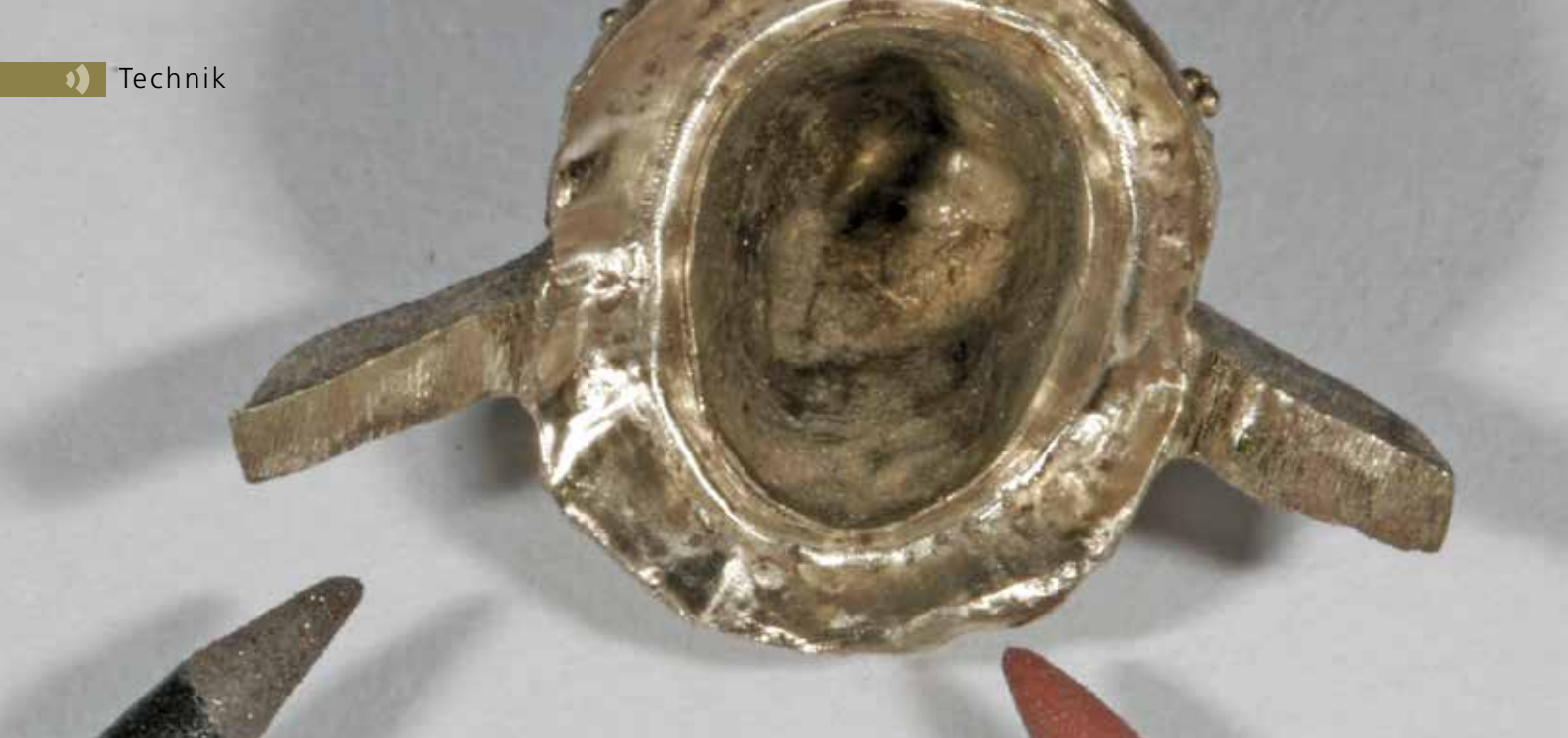
Abb. 78: Schrittweises Ausarbeiten der Teleskopschürzen mit Mikropolierern. Blick von basal auf das Teleskop mit eingesetztem Primärteil.
