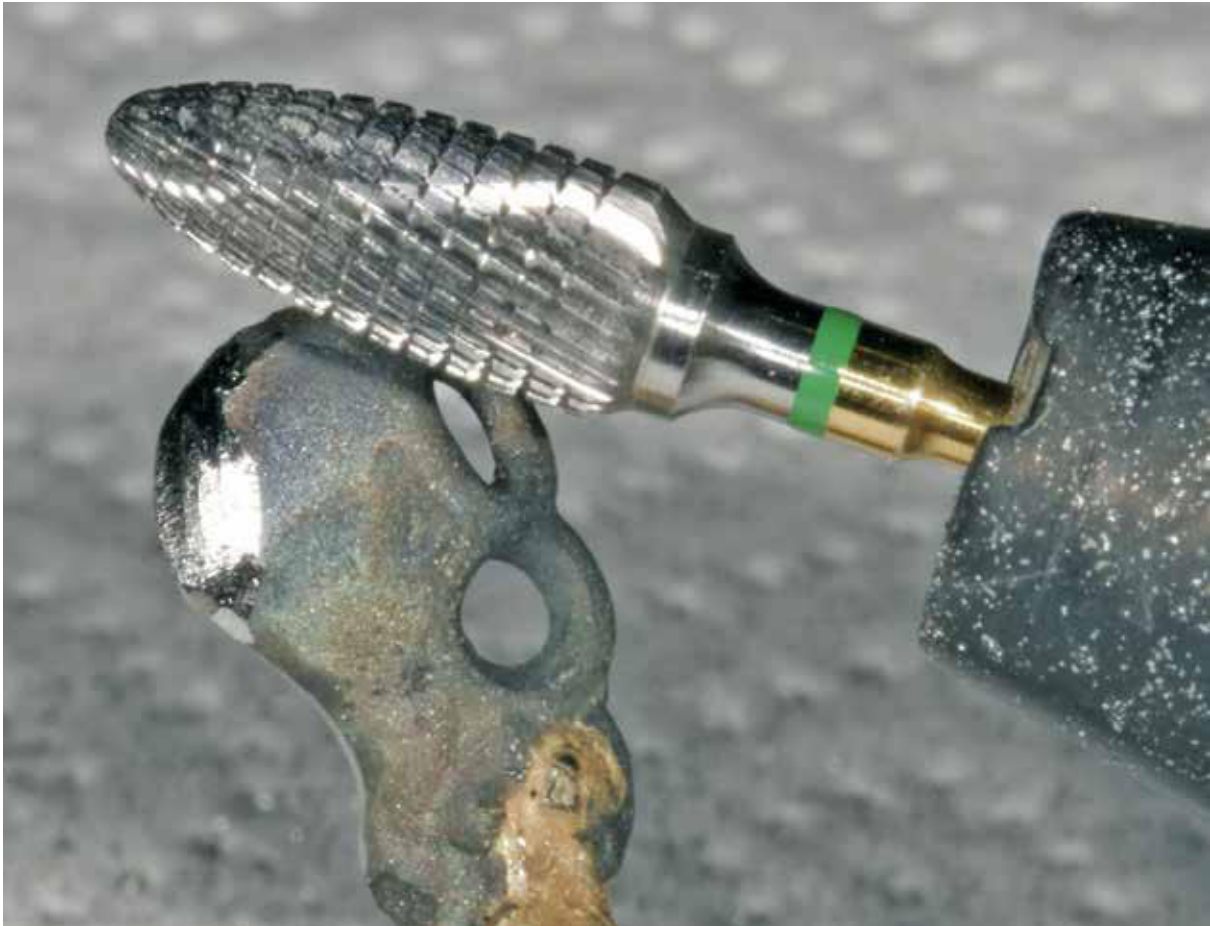
Abb. 86: Ausarbeiten mit dem NEX-Hartmetallfräser.
