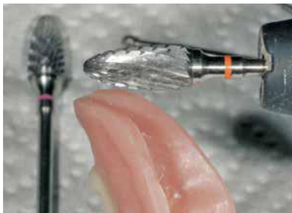
Abb. 108: Ausarbeiten mit den Dualfräsern.
