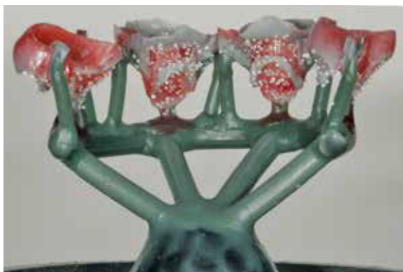
Abb. 65: Mit Retentionsperlen angestiftet im offenen Ring.
