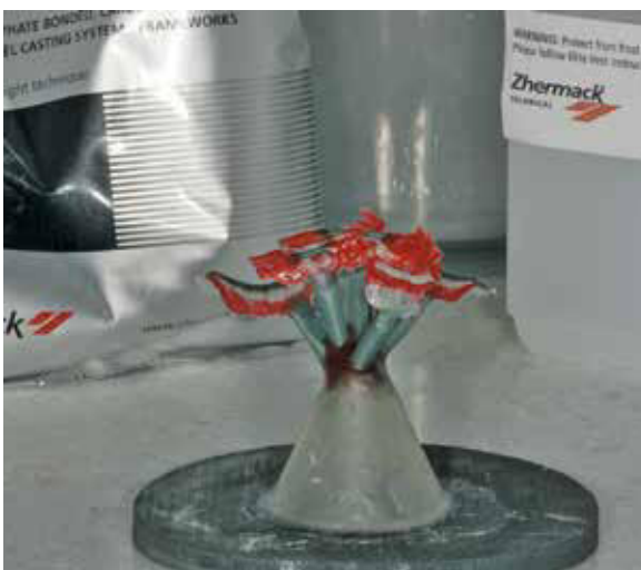
Abb. 72: Einbetten und Gießen im Speed-Verfahren.
