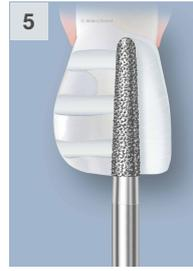
3. 即使在非常陡的角度使用该器械，工作端的锥形形状及其圆形尖头也能提供安全保护，而不会出现磨削量过大的问题。
