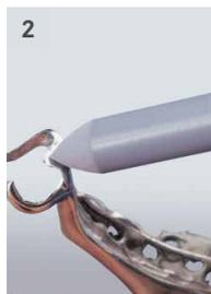
2. Оклюзионные поверхности приобретают глянец при помощи инструмента 9702F.900.060.
